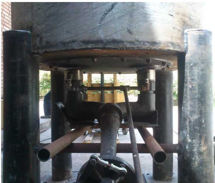
شکل ۶- مشعل اتمسفریک همگام‌سازی شده شرکت شعله صنعت براساس مشعل موجود شرکت پالایش نفت آبادان، نصب شده بر روی بستر آزمون [۱]
