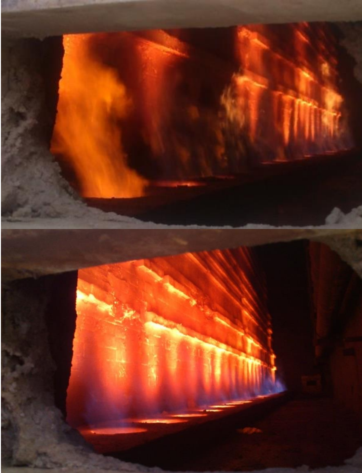
شکل ۸- مقایسه پخش دمایی شعله مشعل‌ها بر روی دیواره میانی در ناحیه تشعشع کوره H-H1: عکس بالایی شرایط شعله‌ها قبل از تغییر مشعل‌ها و عکس پایینی شرایط شعله‌ها پس از جایگزینی مشعل‌ها می‌باشد. [۱]
